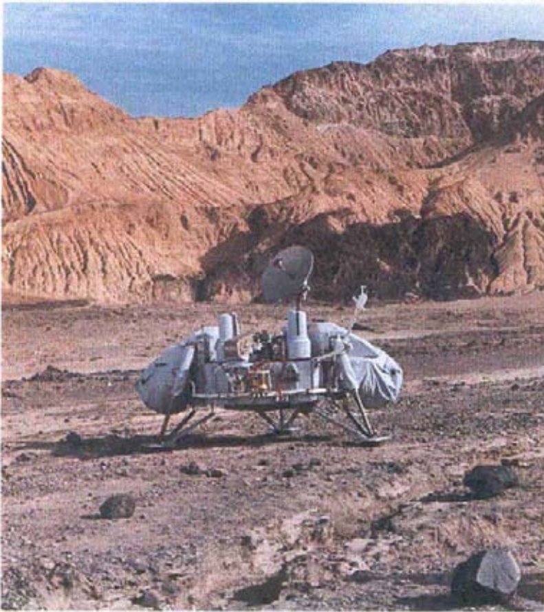
Viking Lander, na simulação do Vale da Morte, Califórnia. Entre dois torreões com câmeras de televisão está o depósito do braço de recolhimento de amostras, ainda não desenrolado.
