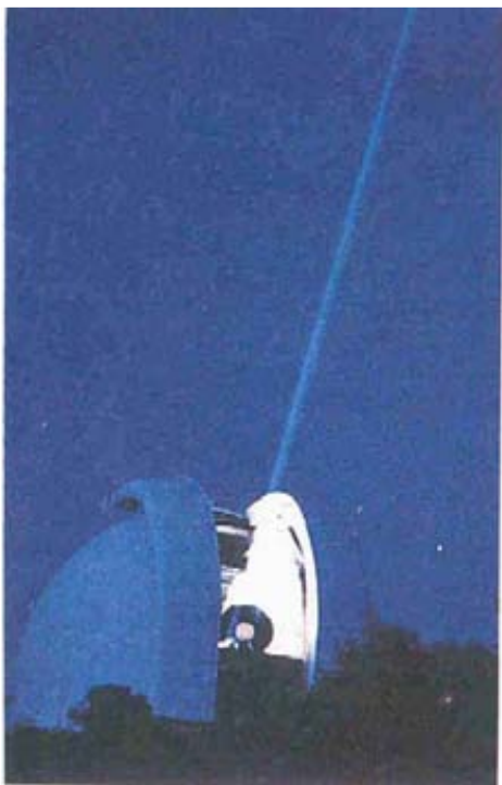
Raio laser direcionado para os retro-refletores embasados na superfície lunar. O telescópio é o refletor de 82 polegadas do Observatório McDonald, Universidade do Texas.
